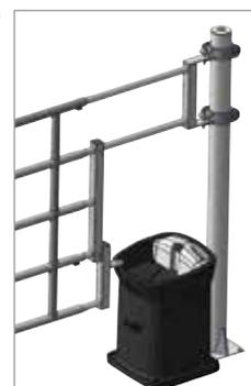
Einschubteil mit einer Tränke/Säule Ausnehmung. Befestigung-Zwischenachse für die Säulenausnehmung: 340 mm. Befestigung-Zwischenachse für die Tränkeausnehmung: 948 mm. Nur mit den Ø 42,4 mm Weidetor Hauptteilen kompatibel.
