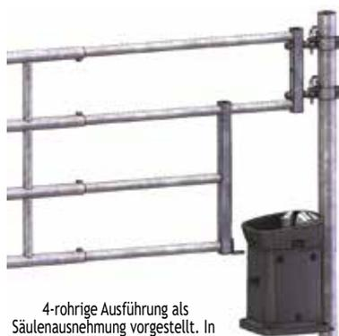
4-rohrige Ausführung als Säulenausnehmung vorgestellt. In diesem Fall eine zusätzliche Ø 22 mm Augengewindespindel Art.-Nr. 115 50 01 bestellen und im Oberteil anbringen.
