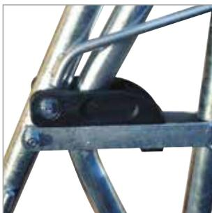
„Gummifeder“ patentiertes System auf jedem beweglichen Hebel zur automatischer Rückkehr in die geöffnete Position mittels einer Gummifeder auf Gleitschiene. Die Befestigungsachse des beweglichen Hebels ist mit einem Verstärkungsring ausgerüstet, um eine gute Lebensdauer zu gewährleisten.
