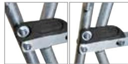
Patentierter, auf Zahnstange montierte „Einseitige Gummifeder“ auf jedem beweglichen Hebel zur automatischen Rückkehr in geöffneter Position. Die Befestigungsschasse des beweglichen Hebels ist mit einem Verstärkungsring ausgerüstet, um eine gute Lebensdauer zu gewähren. Die einseitige Gummifeder ist vor den Kälbern geschützt.
