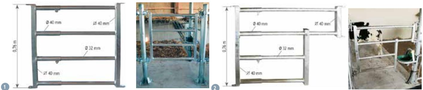
Die ausziehbaren kleinen Türen, als Abtrennung oder mit Tränkenausnehmung, sind unverzichtbar zur Einrichtung von kollektiven Kälberboxen.
