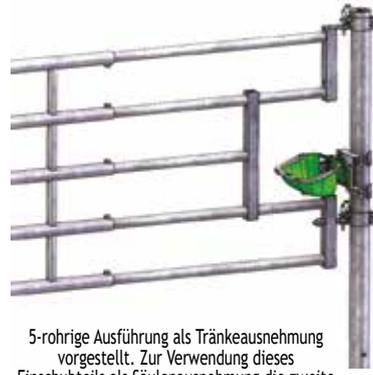
5-rohrige Ausführung als Tränkeausnehmung vorgestellt. Zur Verwendung dieses Einschubteils als Säulenausnehmung die zweite Ø 22 mm Augengewindespindel im Oberteil des Einschubteils anbringen. Kann optional mit einer dritten Augengewindespindel ausgerüstet werden.
