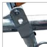
Beweglicher Hebel im Oberteil mit einem Lärmschutzpuffer ausgerüstet, um den Stress der Tiere zu vermeiden.
