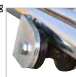
Die untere Führung aus Ertalon ist auf Träger angeschraubt, die direkt am Selbstfangfressgitterrahmen angeschweißt sind.
