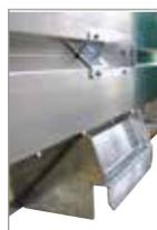
Dreipunktaufhängung, durch eine dicke, verschraubte Platte verstärkt.
