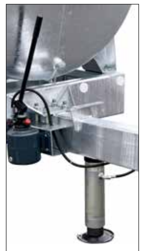
Hydraulische Stütze mit Pumpe und serienmäßiger Reserve für die 8000 l Ausführung. Die Einheit ist mit einem Vierteldrehungsventil und Push-Pull-Anschlüssen ausgerüstet, durch die der Schlauch abgenommen werden kann, wenn das Wasserfass auf dem Feld bleibt.
