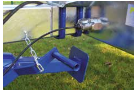
Verlängerungskabel bis zum Schlepper inbegriffen, um Beschädigung des Kabelstranges durch Tiere zu vermeiden. Anschluss der hinteren Leuchten mit direkter Kabeldurchführung im Gestell.
