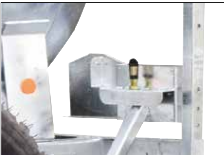
Geschützte Verkabelung, Anschluss für Drehlampe hinten.
