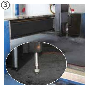
3 entsprechend der erstellten CAD-Zeichnung werden die Schlitze mit innovativer Wasserstrahl-Schneidetechnologie passgenau in die Matten geschnitten
