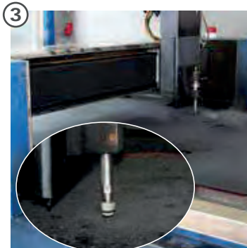
3 entsprechend der erstellten CAD-Zeichnung werden die Schlitzte mit innovativer Wasserstrahl-Schneidetechnologie passgenau in die Matten geschnitten
