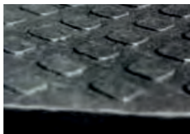
gewölbte Oberfläche mit Quadratprägung
