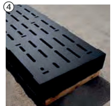
3 entsprechend der erstellten CAD-Zeichnung werden die Schlitzte mit innovativer Wasserstrahl-Schneidetechnologie passgenau in die Matten geschnitten
